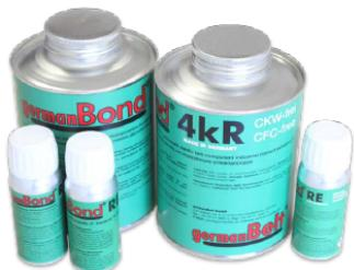
**Aplicación:** Adhesivo de contacto de dos componentes libre de CFC y de elasticidad permanente para uniones de goma-goma, goma-tela, goma-metal, tela-tela, etc. como, por ejemplo, la unión en frío de bandas transportadoras de goma, revestimientos de protección contra el desgaste y recubrimientos de tambores y rodillos.
